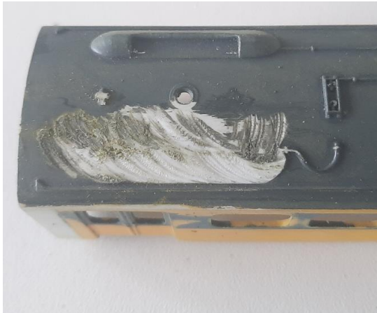
Weg-dremelen van de acht aanwezige pantograaf schuitjes op de beide kopbakken...
