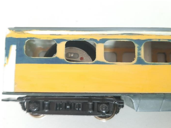
Motordraaistel met nieuwe zijanten onder de Br bak...
