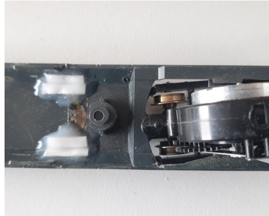
Bodem versterking bij frame deel met het motor draaistel...
